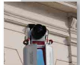
камера NIKON DSLR синхронизированная по GPS
